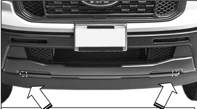
(Fig. 5a) Pour les modèles sans crochets de remorquage, découper les ouvertures dans le couvercle inférieur en plastique pour dégager
