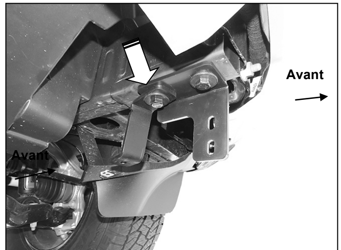
(Fig. 7) Support de châssis gauche/conducteur installé avec le support de plaque de protection en option (flèche)
